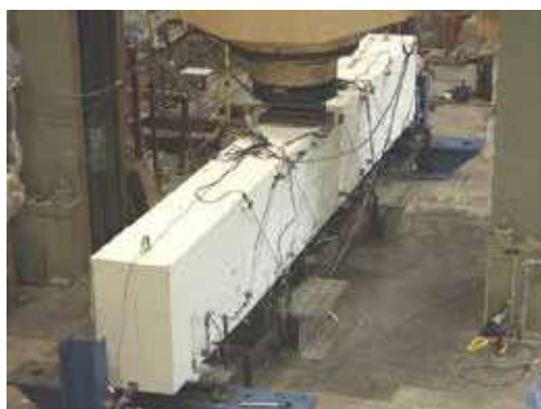
＜梁のせん断破壊実験＞
